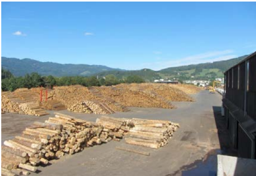
Grande quantità di tondame, scortecciato e fresato attende di essere segato
