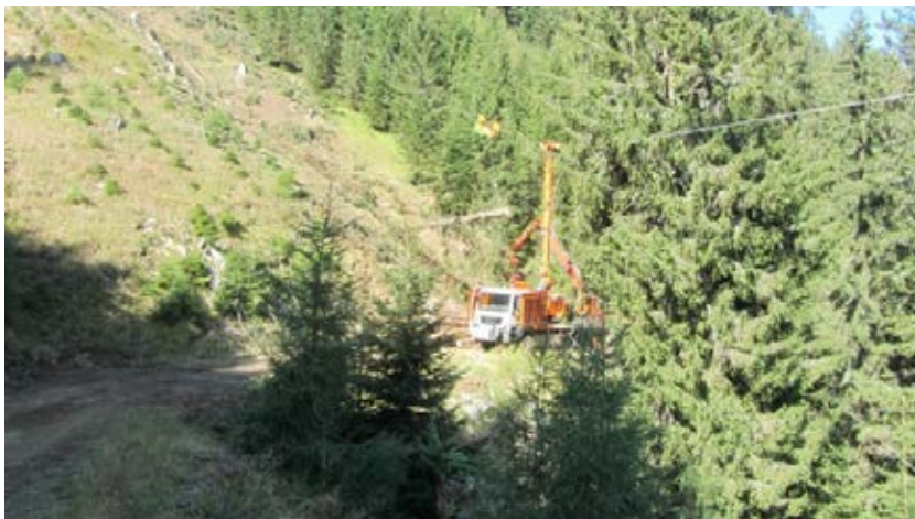
Seilgerät “Syncofalke 3t” im Einsatz; hier in der Bergabseilbringung
